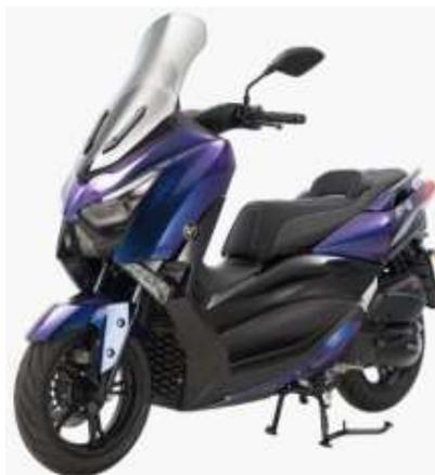
Motore raffreddato ad aria da 175 cc, Euro 5, Iniezione EFI, Impianto frenante CBS, Freni a disco anteriore e posteriore, Tachimetro TFT, Keyless, Cerchi in lega da 13 pollici Ant.& Post. 13 post., Doppio ammortizzatore
