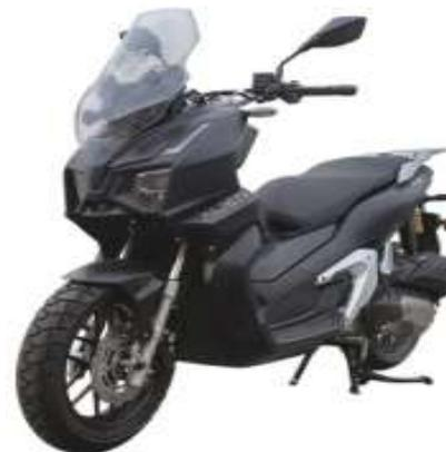
Motore raffreddato ad acqua da 125 cc, 4 valvole, Iniezione Bosch EFI, Euro5+, Impianto frenante CBS, Freni a disco anteriore e posteriore, Tachimetro TFT, Cerchi in lega da 14 pollici ant. 13 post., Doppio ammortizzatore posteriore a gas
