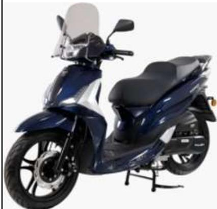
Motore 125 cc, Iniezione EFI, Euro5+, Impianto frenante CBS, Freni a disco anteriore e posteriore, Tachimetro TFT, Cerchi in lega da 16 pollici
