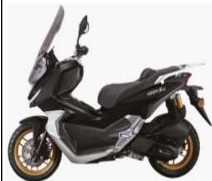
Motore raffr. ad acqua da 125 cc, 4 valvole, Tecnologia H. Pcx, EFI, Euro5+, ABS freno anteriore, Freni ant/post. a disco, Tachimetro TFT, Avv. KEYLESS, Cerchi in lega da 14 pollici, Pneum. tubeless, Presa USB e tipo C per caricabatterie telefono, Parabrezza regolabile, Portapacchi posteriore in alluminio, Doppio ammortizzatore posteriore
